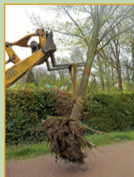
Die Linde wurde mit einem Radlader ausgehoben und zum neuen Pflanzloch transportiert.
