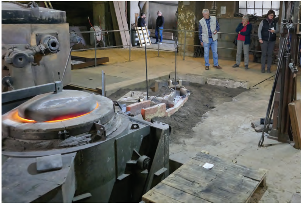
In der Gießhalle: Schmelzofen, Gießgrube mit Gießkanal und den von einer Sandschicht verdeckten Gussformen für die beiden neuen Glocken der Thomaskirche
