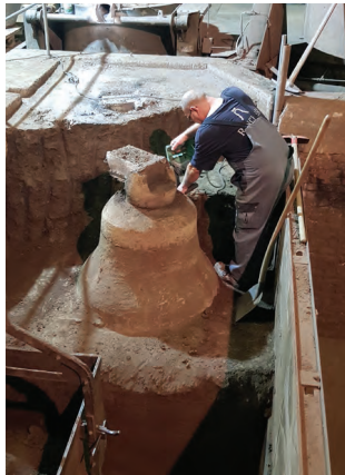
24. September: Vier Tage nach ihrem Guss sind die Glocken abgekühlt. Der Sand aus der Gießgrube konnte entfernt werden. Nun werden Vorbereitungen für das Heben der Glocken getroffen.
