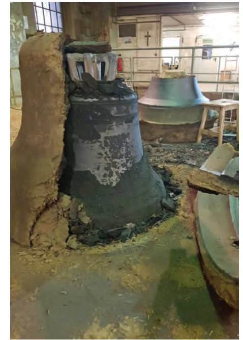
Der Lehmmanuel ist teilweise entfernt. Die Glocke wird, wenn auch vorerst nur im Rohguss, sichtbar.
