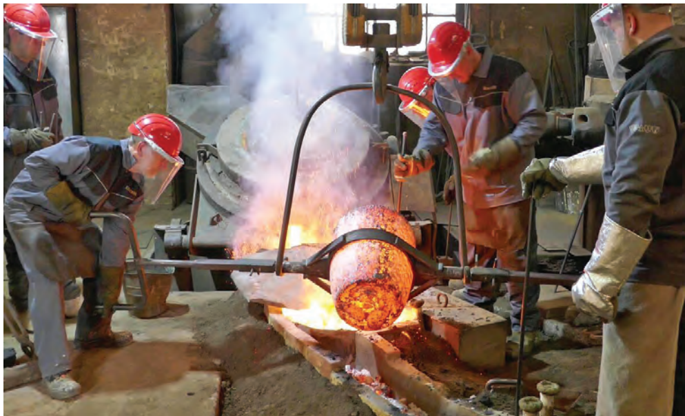
Während des Gussvorgangs: Aus einem Tiegel wird zusätzliche glutflüssige Bronze in den Gießkanal gegeben. Foto: Heuer
